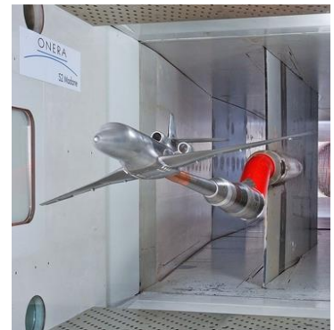
Figure 1. Maquette avionique montée sur le système porte-dard dans la soufflerie S2MA
