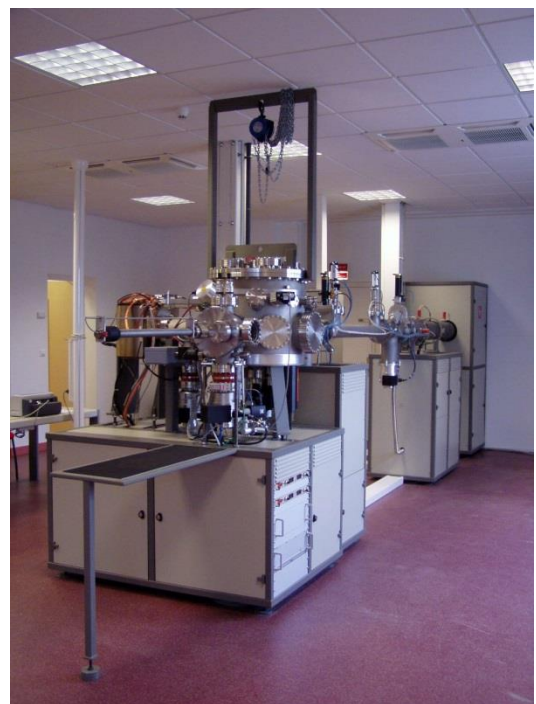
Figure 1. Système de spectrométrie par diffusion d'ions de moyenne énergie (MEIS) destiné à l'analyse chimique et structurale d'objets de tailles nanométriques
