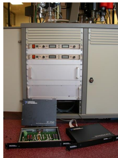
Figure 3. Le matériel NI de pilotage des alimentations HT et des relais de commande des obturateurs a été intégré dans la baie 19" de l'équipement.
